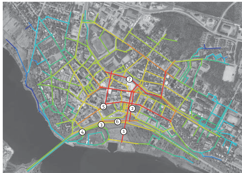
Figur 97. Axialkarta som visar hur integrationen för Kalix gång- och cykelnät skulle se ut efter vissa förändringar i strukturen.
