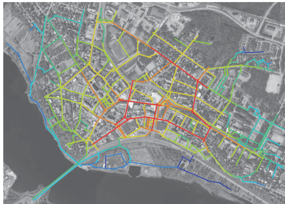
Figur 96. Axialkarta som visar integrationen vad gäller gång- och cykelnätet i Kalix centrum. Ju rödare färg desto högre integrationsvärde. Blå färg visar på låg integration.
