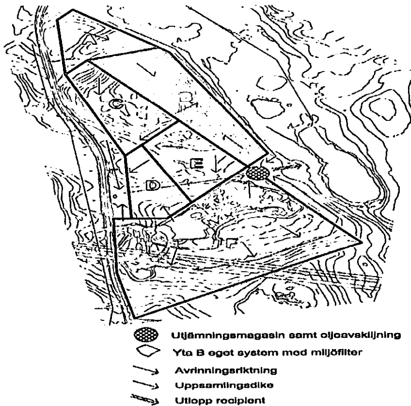
Fig 4. Yt och dagvattensystem med utsläppspunkt till recipient
